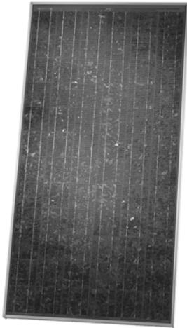
Los módulos solares SX-110 están formados por 72 células solares de silicio multicristalino en serie con diodos de derivación. Los módulos solares están equipados con clavijas y enchufes para la conexión fácil de varios módulos en paralelo o en serie. Los módulos solares deben montarse en una estructura de soporte, inclinada un determinado ángulo para asegurar el óptimo aprovechamiento de la energía solar.
