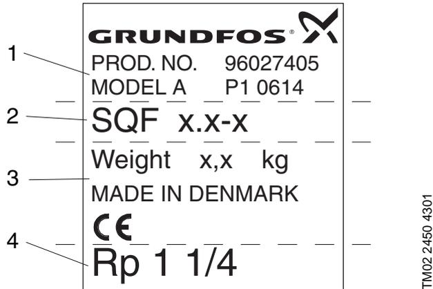
Fig. 1 Placa de características, bomba de rotor helicoidal
